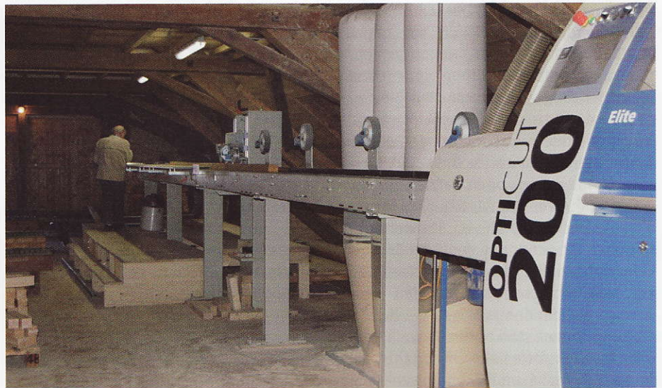
Die OptiCut schneidet die Hölzer automatisch heraus, die Gutteile werden in Boxen absorbiert und die Resthölzer werden über den automatisch gesteuerten Abfallschacht abgezogen. (Bild Josef Bucher AG)
